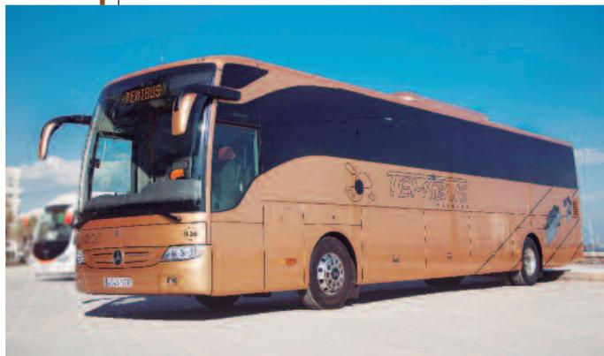
**LA EMPRESA ALICANTINA TEMIBUS** acaba de renovar su flota con un Turismo RHD-M/2A Mercedes-Benz de 12,96m de longitud y 3,65m de altura. El autocar está equipado con motor OM 457 hLA y cuenta con 55 plazas, más guía y conductor en un equipamiento de gran confort, que ha personalizado para los servicios discrecionales de congresos y eventos de todo tipo que realiza.
