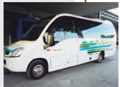
El COMPA T carrozado sobre el chasis DAILY IVECO con una potencia de 170 CV tiene una longitud de 7,798 metros y ofrece hasta 29 plazas más conductor, con una capacidad en sus maleteros de hasta 4 m<sup>3</sup>.
