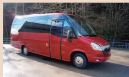
**MONTADO SOBRE UN BASTIDOR 70C17** de IVECO, el modelo WING de 28 plazas, lleva detector de incendios incorporado y dispone de una nevera coolmatic. Su cabezal integrado en polipiel, así como ribetes en cada una de sus butacas y el pavimento imitando madera, son algunos de los accesorios que componen este vehículo turístico.
