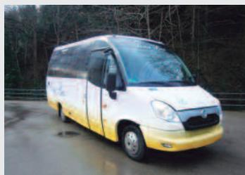
**MONTADO SOBRE UN BAS-TIDOR 70C17 de IVECO** el modelo WING de 28 plazas, posee una plataforma para el transporte de hasta 6 personas con movilidad reducida, y cumple la
