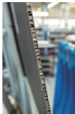
Paneles interiores aligerados sin perder resistencia.
