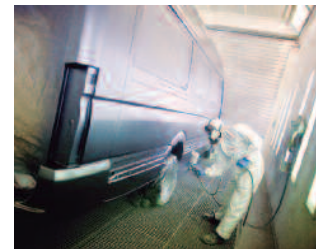
Interior de una cabina de pintura.
